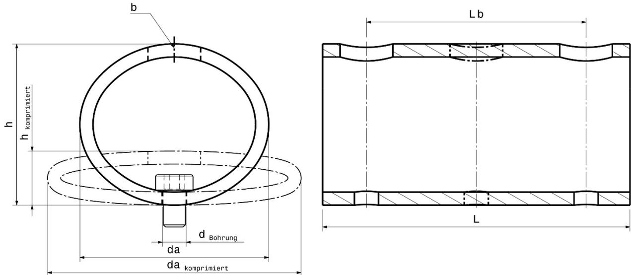
Die RTB Dämpferserie wurde für Anwendungen entworfen, bei denen eine weiche und progressive Energieabsorption gefordert wird. Mit 2 bzw. 3 Schrauben ist der Dämpfer sowohl horizontal als auch vertikal einfach zu befestigen.
