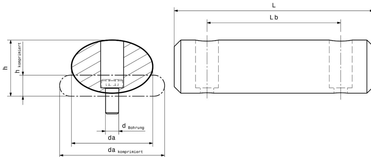
Die HRB Dämpferserie wurde entworfen, um ein Maximum an Energie bei einem Minimum an Bauteilhöhe aufzunehmen. Mit zwei Schrauben ist der Dämpfer sowohl horizontal als auch vertikal einfach zu befestigen.
