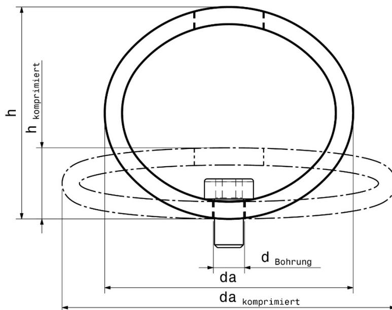
Die GBR Dämpferserie wurde für Anwendungen entworfen, bei denen eine lange und weiche Energieabsorption gefordert wird. Mit nur einer Schraube ist der Dämpfer sowohl horizontal als auch vertikal einfach zu befestigen.
