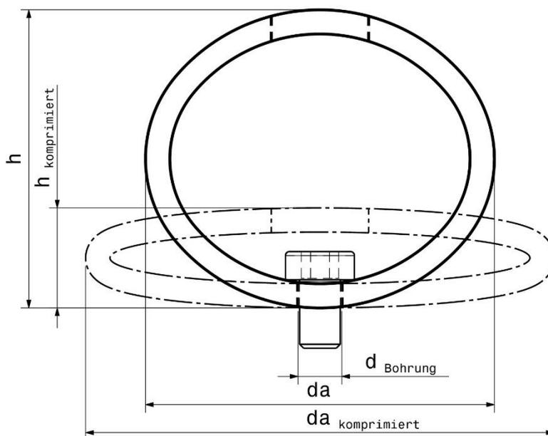
Die GBR-H Dämpferserie wurde für Anwendungen entworfen, bei denen eine lange und weiche Energieabsorption gefordert wird. Mit nur einer Schraube ist der Dämpfer sowohl horizontal als auch vertikal einfach zu befestigen.
