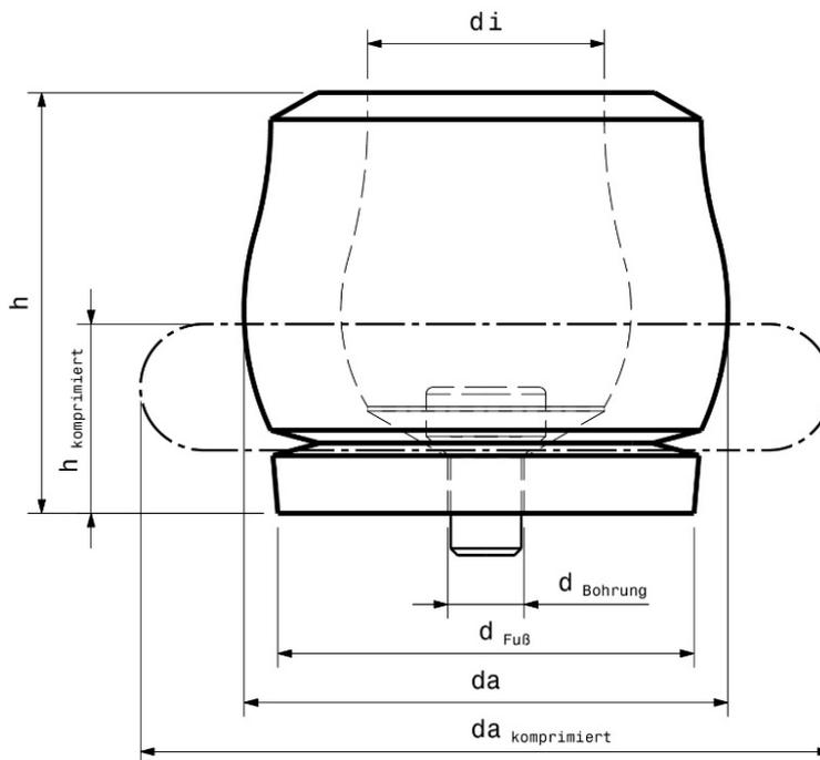
Die GBA Dämpferserie wurde entworfen, um ein Maximum an Energie zu absorbieren bei einem Minimum an Bauteilhöhe und Bauteilgewicht. Mit nur einer Schraube ist der Dämpfer sowohl horizontal als auch vertikal einfach zu befestigen.
