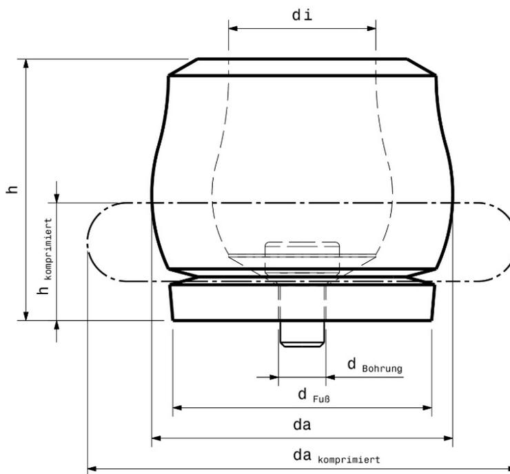
Die GBA Dämpferserie wurde entworfen, um ein Maximum an Energie zu absorbieren bei einem Minimum an Bauteilhöhe und Bauteilgewicht. Mit nur einer Schraube ist der Dämpfer sowohl horizontal als auch vertikal einfach zu befestigen.
