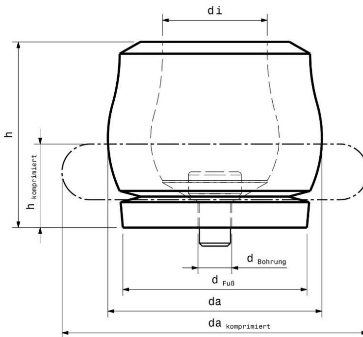
Die GBA-S Dämpferserie wurde entworfen, um ein Maximum an Energie zu absorbieren bei einem Minimum an Bauteilhöhe und Bauteilgewicht. Mit nur einer Schraube ist der Dämpfer sowohl horizontal als auch vertikal einfach zu befestigen.
