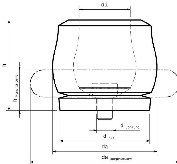
Die GBA-S Dämpferserie wurde entworfen, um ein Maximum an Energie zu absorbieren bei einem Minimum an Bauteilhöhe und Bauteilgewicht. Mit nur einer Schraube ist der Dämpfer sowohl horizontal als auch vertikal einfach zu befestigen.
